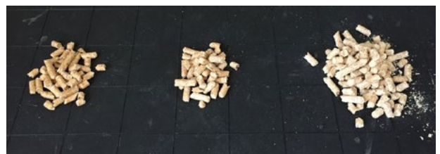
Abb. 5: Pellets mit unterschiedlichen Feuchtegehalten (v.l.n.r.: 14%; 18%; 25%), [3]
