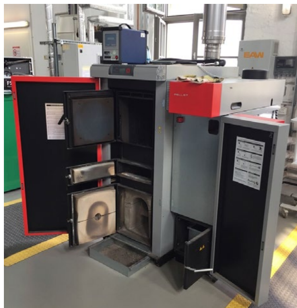
Abb. 3: Versuchsanlage zur Verbrennung von Stückholz und Pellets, [3]
