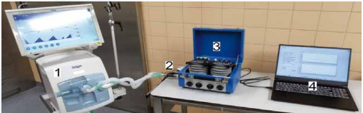
Abbildung 2: Versuchsaufbau im Tieroperationssaal – (1) Beatmungsgerät Dräger Infinity C500 mit Beatmungsschlauch, (2) Sensor Sensirion SFM3019 & USB-Modul National Instruments USB-8452, (3) Modellung von IngMar Medical, (4) PC mit VI für Sensor
